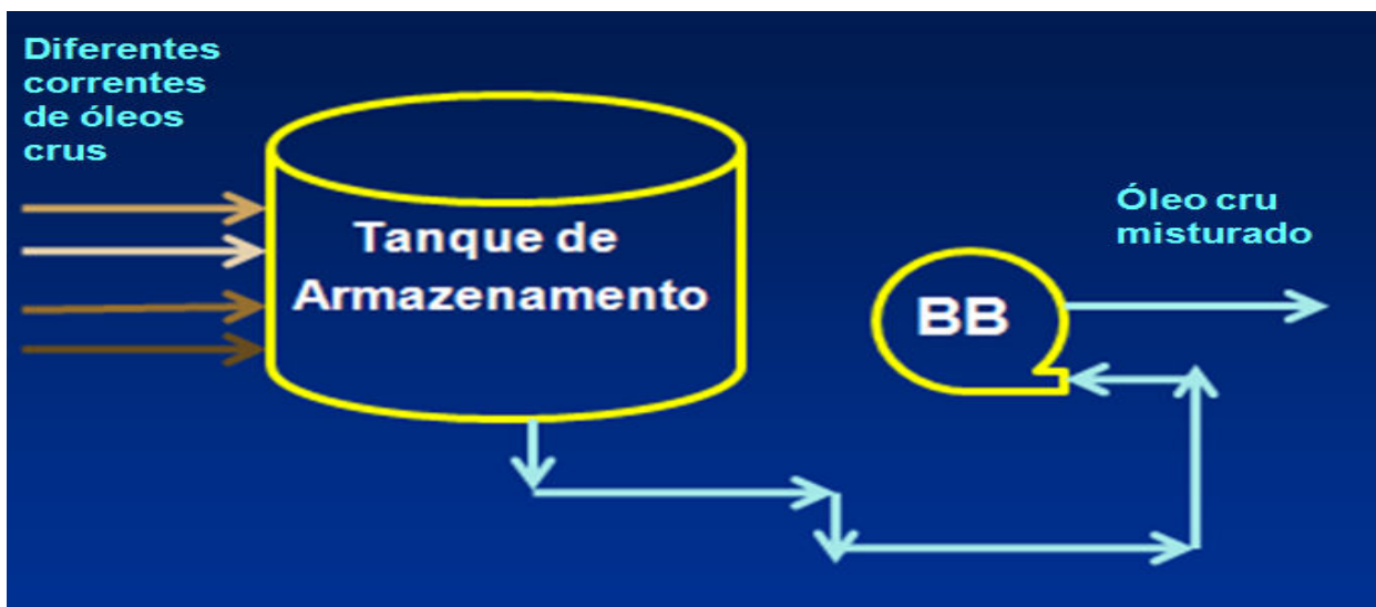
Figura 10 – Armazenamento de diferentes óleos crus e bombeamento de óleo cru misturado.
